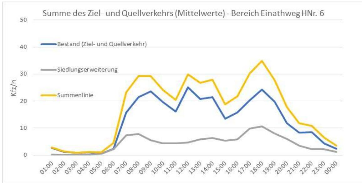
Abb. 7: Summe des Ziel- und Quellverkehrs (Mittelwerte); Bestand und Neuerkehr
